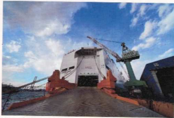
La rampa d'accesso della nave
