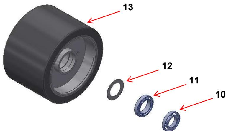
Sostituire la ruota con un ricambio (codice 2415.A3A.GN008) avente le medesime caratteristiche e procedere a ritroso per il montaggio.
