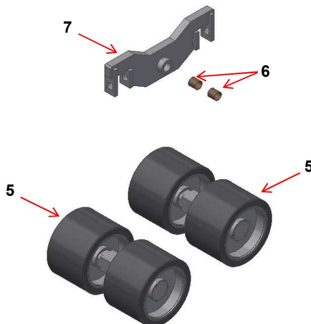
Sostituire il bilanciere con un ricambio (codice 2415.A3A.GN003) avente le medesime caratteristiche e procedere a ritroso per il montaggio.
