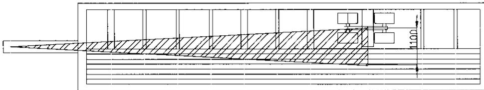
**Il sistema di assalotti pendolari assicura un discreto assorbimento di avvallamenti ed eventuali asperità del terreno: il carrello è comunque progettato e realizzato per un uso interno e per una velocità massima di 6 km/h anche in assenza di carico.**
